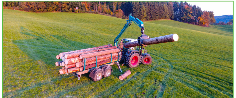
Holzarbeiten mit dem Rückewagen
